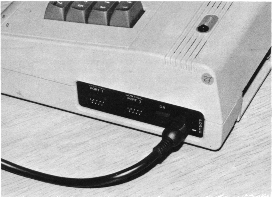
Figura 1.3. Collegamento del cavo di alimentazione al C-64 sulla destra dell'interruttore di accensione.
