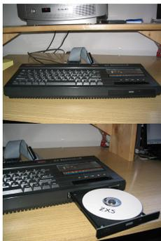
Amstrad acquistato in Spagna poco tempo fa del quale sono state poi pubblicate le foto che potete notare. L'obsoleto registratore e' stato sostituito con un lettore CD da portatile rinunciando anche alla porta stampante utilizzata per far passare il flat che collega
