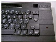
e' su standard DIN con le seguenti piedinature: R,G,B,Sinc e Sound. Le dimensioni sono: 155 x 322 x 42 mm. Porta tape e joystick (compatibile Kempston e Sinclair), pulsante Reset e regolazione del volume direttamente da pc.
