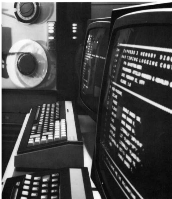
L'S6000 (l'unica foto che possiedo). In primo piano la console, sullo sfondo l'unità di lettura delle bobine di nastro magnetico da mezzo pollice.
