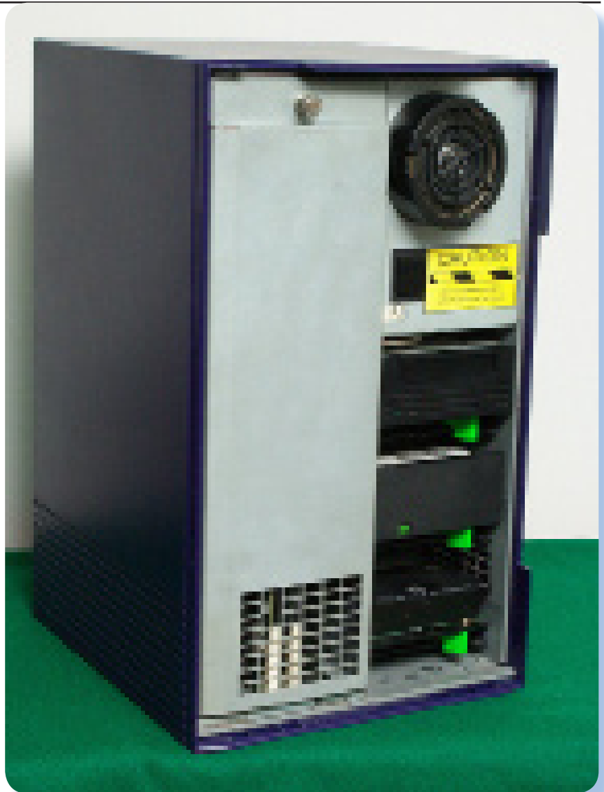
(Figura 3) Rimuovendo il frontale si nota a sinistra lo stretto sportello verticale che accoglie la scheda CPU e la scheda grafica.
