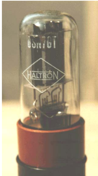
Fig. Una valvola dello stesso tipo (6SN7) di quelle utilizzate nell'ENIAC per la realizzazione dei flip-flop.
