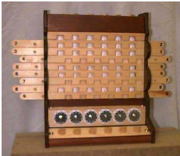
**Fig. Ricostruzione dell'Orologio Calcolatore di Schickard (Deutsches Museum, Monaco).**
