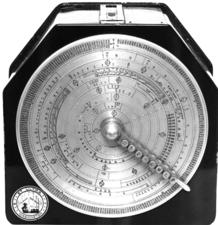
**Fig. Regolo calcolatore modello Washington per il calcolo del cemento armato.**
