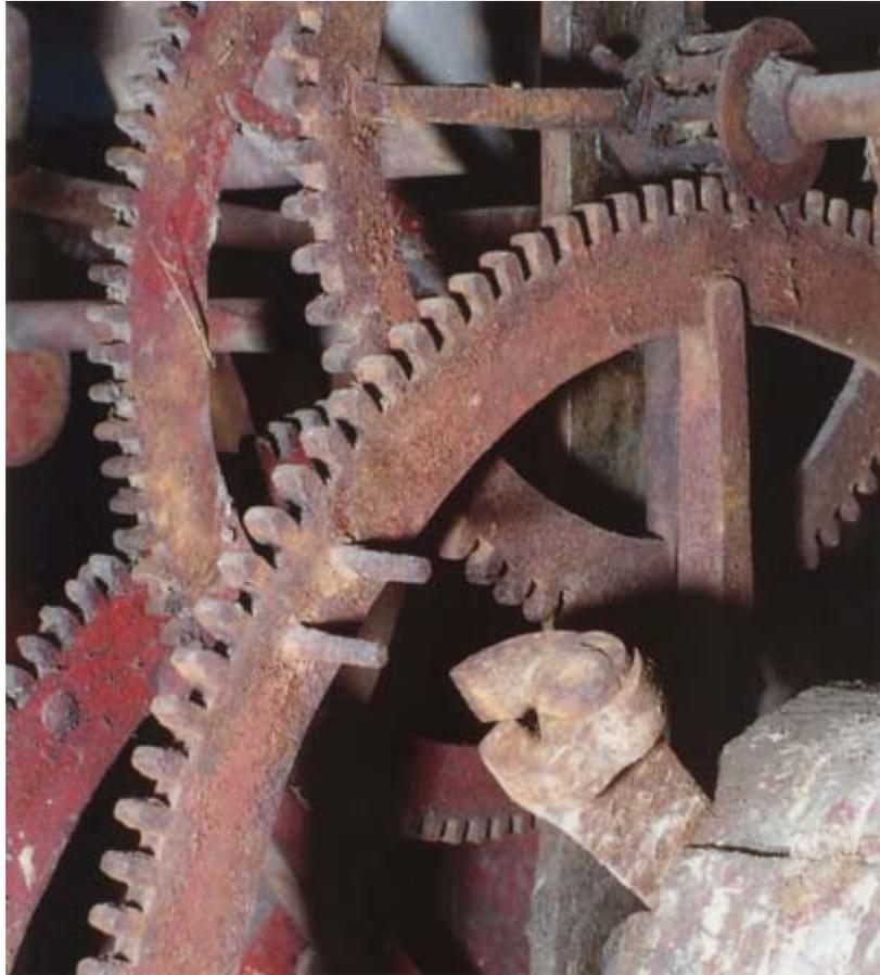
**Fig. Ingranaggi di un orologio.**
