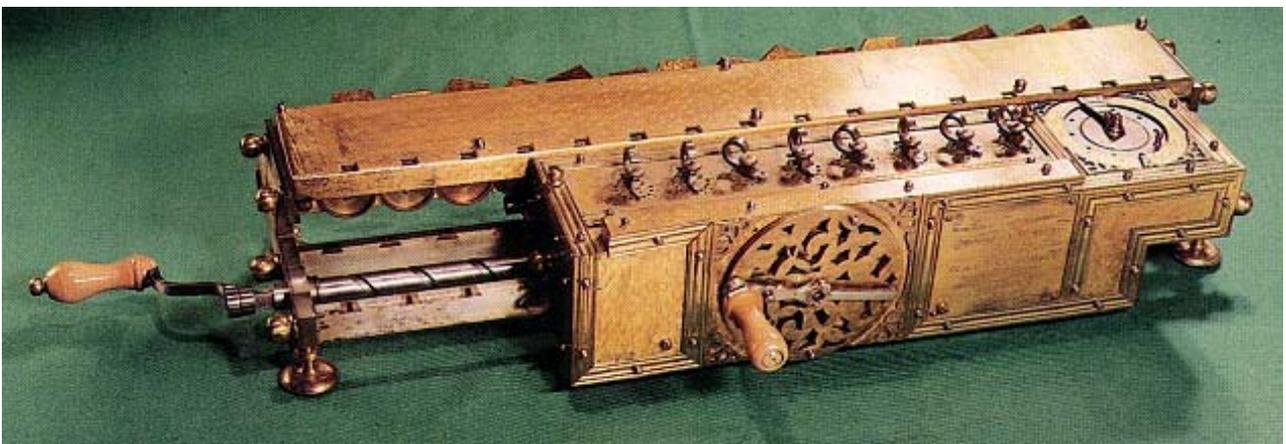
**Fig. Ricostruzione della calcolatrice di Leibniz.**
