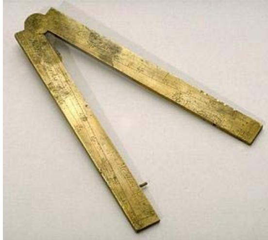
**Fig. Compasso di proporzione, uno degli strumenti analogici più classici.**
