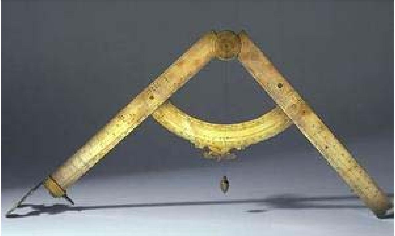
Le sette linee proporzionali tracciate sulle gambe del compasso e le quattro scale segnate sul quadrante, consentivano di effettuare con estrema facilità ogni sorta di operazione aritmetica e geometrica: dalla moltiplicazione all'estrazione delle radici quadrate e cubiche, dal disegno dei poligoni al calcolo di aree e volumi alla misura dei calibri dei cannoni, ecc.
