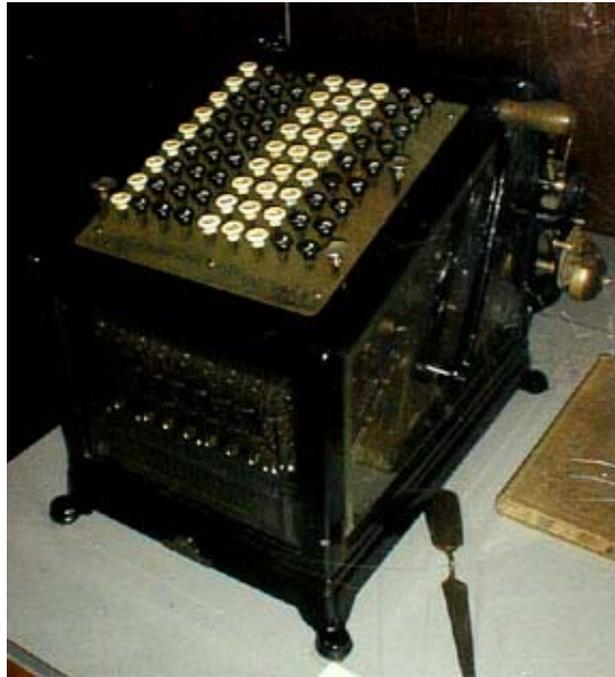
**Fig. Calcolatrice meccanica scrivente della Burroughs.**
