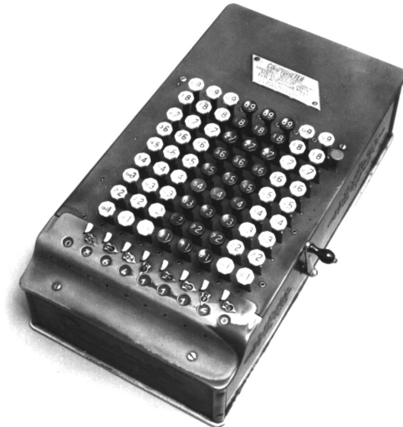
**Fig. Comptometer (ideato da Felt, nel 1884) una delle prime calcolatrici meccaniche per uso commerciale dotate di tastiera.**
