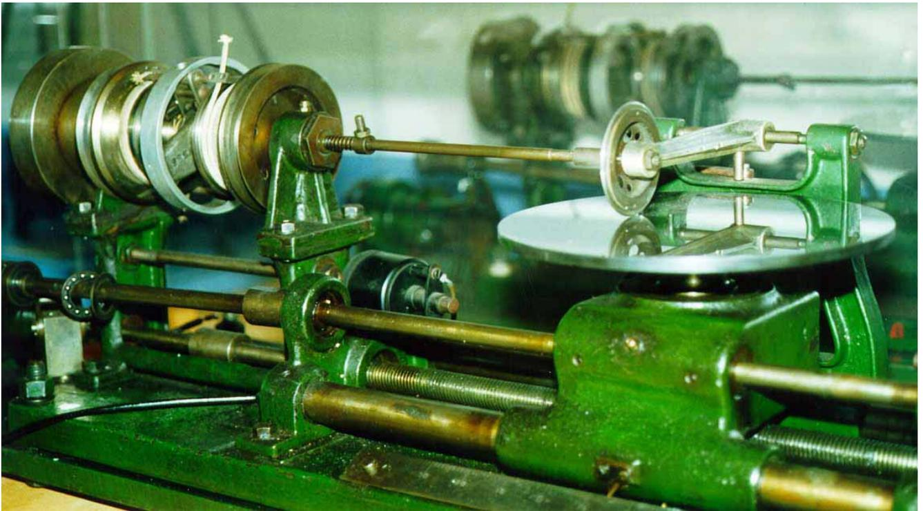
**Fig. Vista delle ruote e dischi di integrazione della macchina. I dispositivi che sembrano dei motori sulla sinistra sono gli “amplificatori di torsione di Nieman”, dispositivi a guida d’argano che funzionavano come amplificatori meccanici per poter procedere nelle successive operazioni di integrazione senza perdita di accuratezza.**
