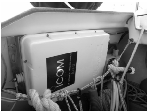
L'accordatore automatico di antenna ICOM AH-3 installato all'interno dello specchio di poppa
