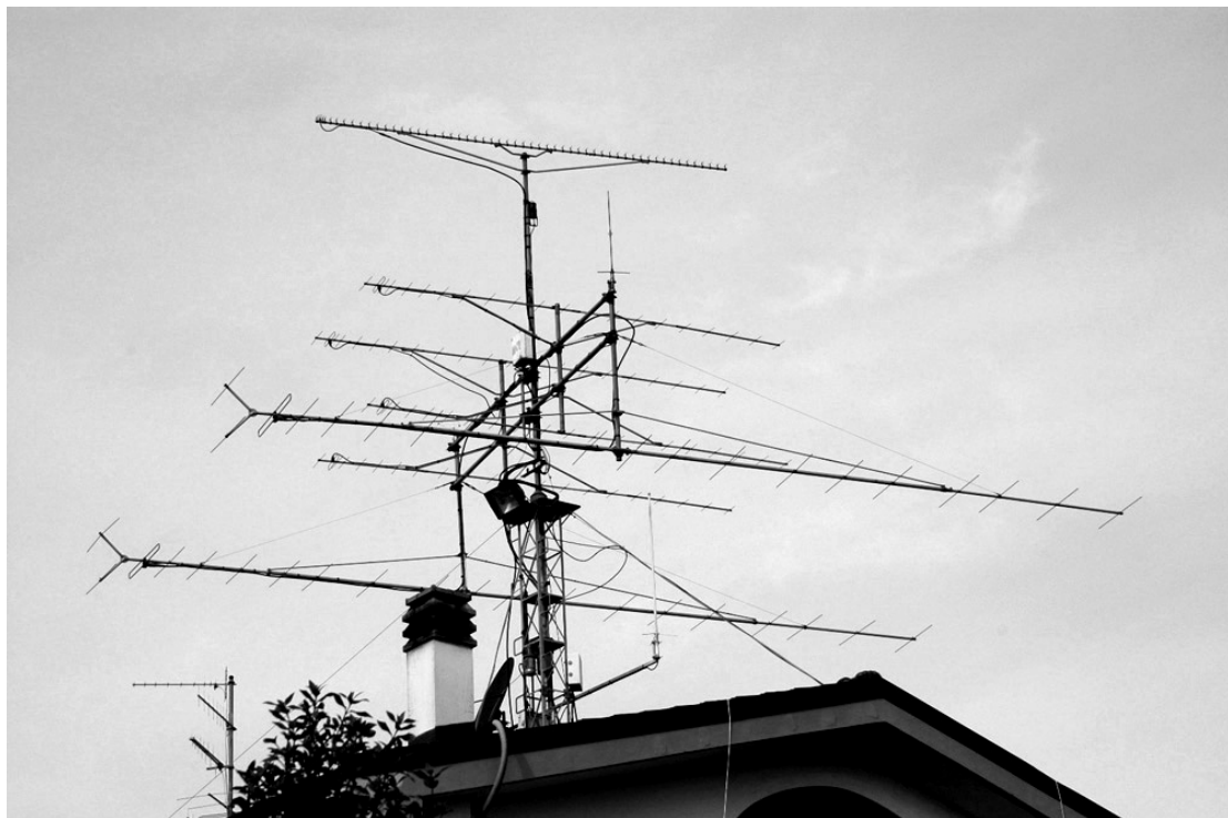
Il sistema di antenne VHF e UHF di IK6CPD 2x20 el 144 Mhz + 4x21 el 432 Mhz + 1x55 el. 1296 Mhz
