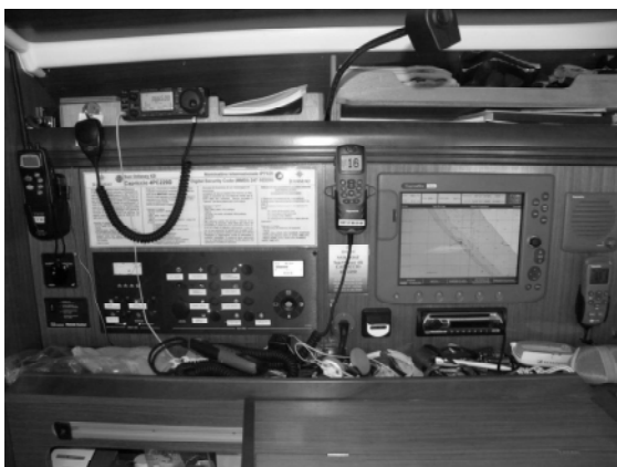
Sopra la lavorazione al tornio del puntale in aculon terminale dell'antenna filare. Sotto il tavolo di carteggio ove è installato il ricetrasmittitore ICOM 706. Un apposito commutatore di antenna smista il collegamento da una bibanda Diamond CX30 V/Uhf dal ricevitore A.I.S. alle bande V/Uhf dell'ICOM 706
