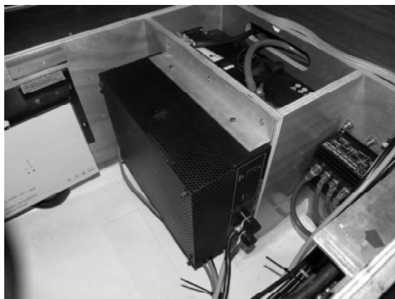
DC-DC converter della ICOM che garantisce 14 volts di tensione sino a 30 Ampere di corrente
