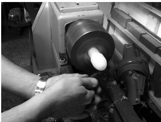
Sopra la lavorazione al tornio del puntale in aculon terminale dell'antenna filare. Sotto il tavolo di carteggio ove è installato il ricetrasmittitore ICOM 706. Un apposito commutatore di antenna smista il collegamento da una bibanda Diamond CX30 V/Uhf dal ricevitore A.I.S. alle bande V/Uhf dell'ICOM 706
