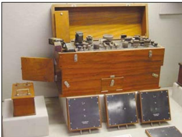
Un ondometro per la misura della lunghezza d'onda dei segnali radiotelegrafici.
