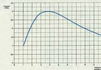
Fig. 11 Curva di risposta di un filtro "largo", disegnato su normale carta a quadretti. Se questa curva venisse riportata sul tracciato logaritmico risulterebbe più simmetrica.
