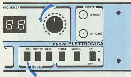
Fig. 19 Senza rimuovere alcun collegamento, pigiate il pulsante CAL (calibrazione) del generatore e, così facendo, eliminerete la funzione Sweep.
