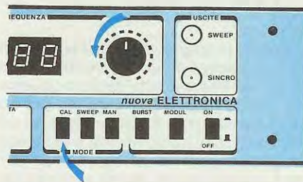
Fig. 26 Per sapere a quale frequenza corrisponde un qualsiasi punto di queste due curve, dovrete pigiare il pulsante CAL, quindi leggere sui display la frequenza generata come già spiegato in fig. 20.
