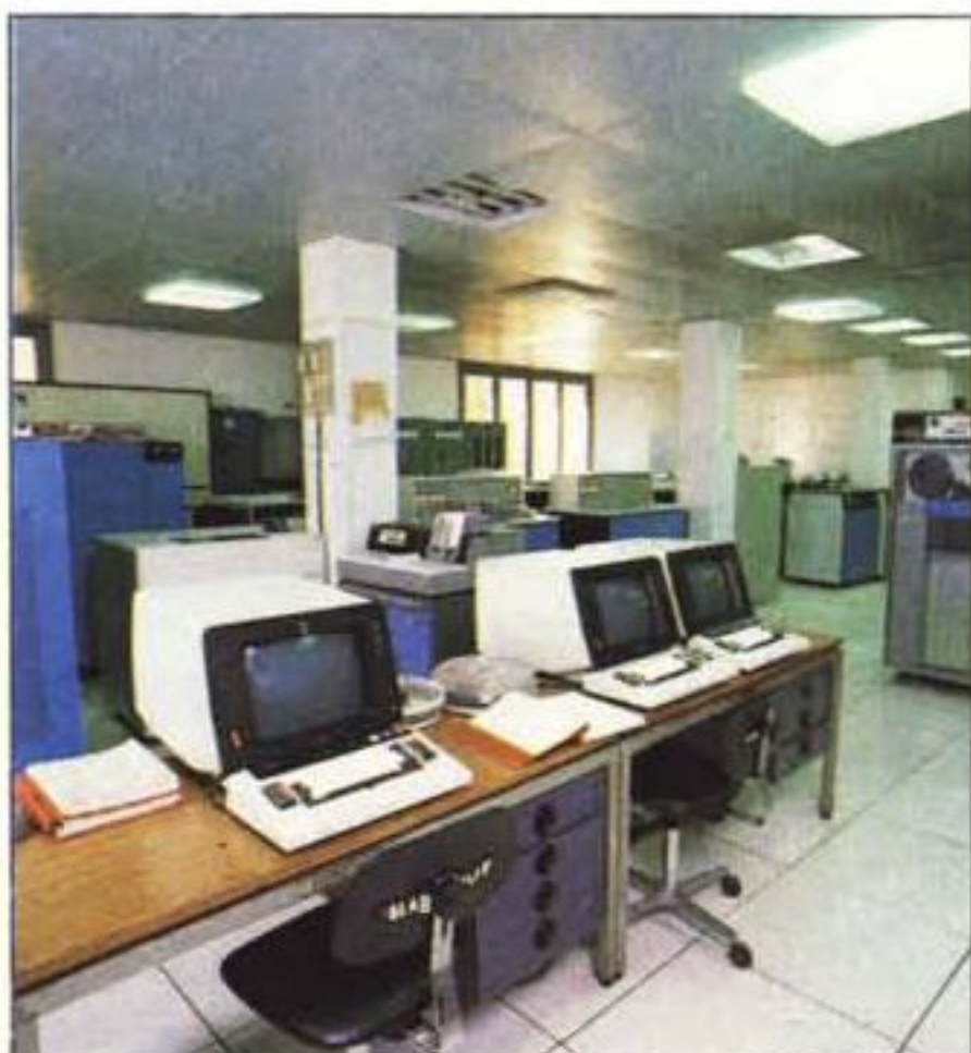
Tre particolari della sala macchine del C.N.M.C.A., che vedete anche in apertura. A sinistra, le tre consolle di sistema. Al centro, le due CPU 4331 IBM, ed in primo piano un sottosistema di controllo dell'I/O. A destra, uno dei due banchi di memorie a disco.
