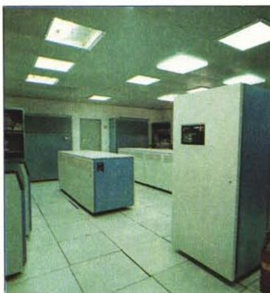
Tre particolari della sala macchine del C.N.M.C.A., che vedete anche in apertura. A sinistra, le tre consolle di sistema. Al centro, le due CPU 4331 IBM, ed in primo piano un sottosistema di controllo dell'I/O. A destra, uno dei due banchi di memorie a disco.
