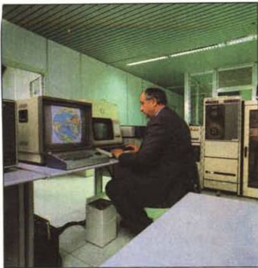
Al C.N.M.C.A. è operante anche una stazione computerizzata per la ricezione e l'elaborazione digitali di immagini Meteosat. Lavorando in modo svincolato da Afrodite, questa sezione raccoglie ed interpreta le immagini che il satellite invia ogni mezz'ora. Dispone di due PDP-11 con hardware addizionale per l'immagine processing di qualità.
