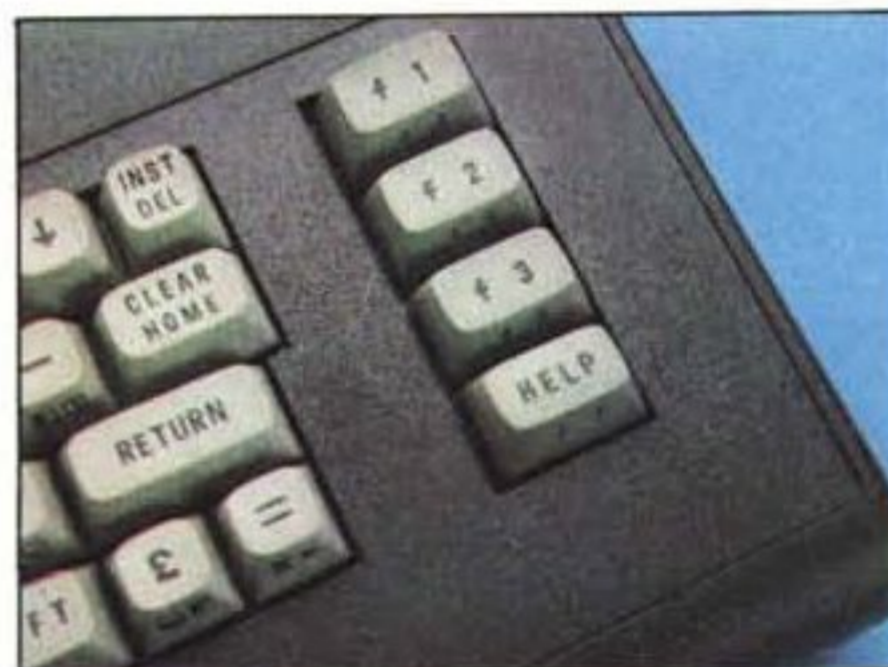
Sul C16 i tasti funzione sono abilitati all'accensione. Le funzioni implementate possono essere anche modificate dall'utente.
