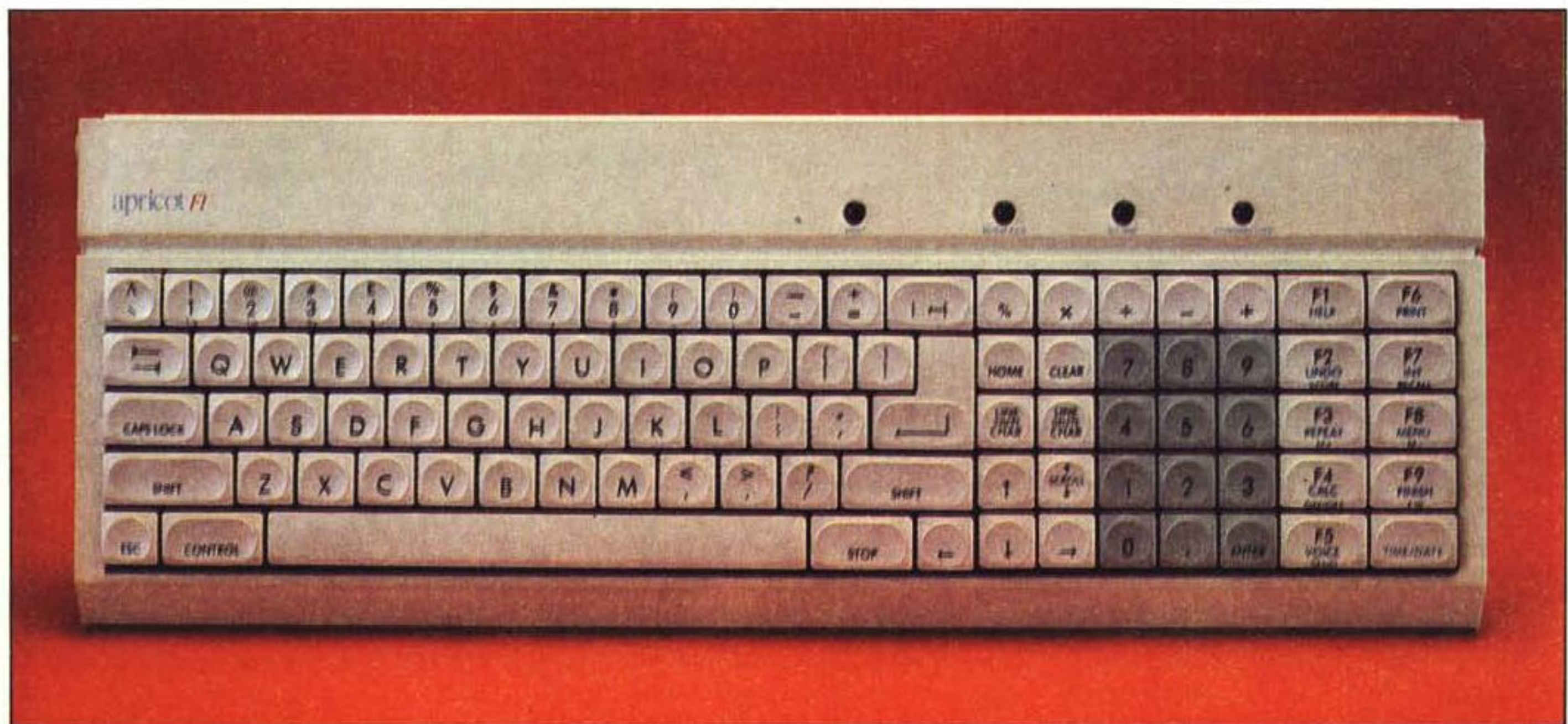
La tastiera comunica col calcolatore attraverso un trasmettitore a raggi infrarossi.
