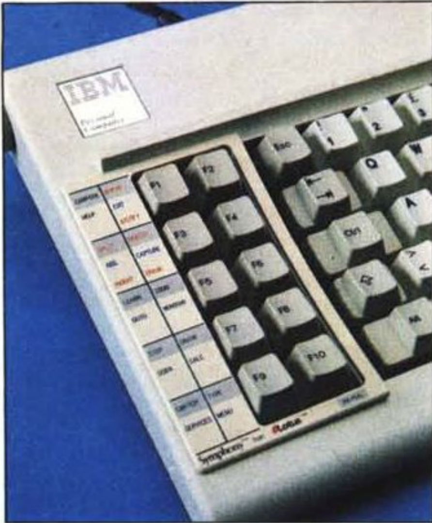
La mascherina mnemonica che riporta le funzioni associate ai tasti definibili. Presto anch'essa sarà disponibile con i comandi in italiano.
