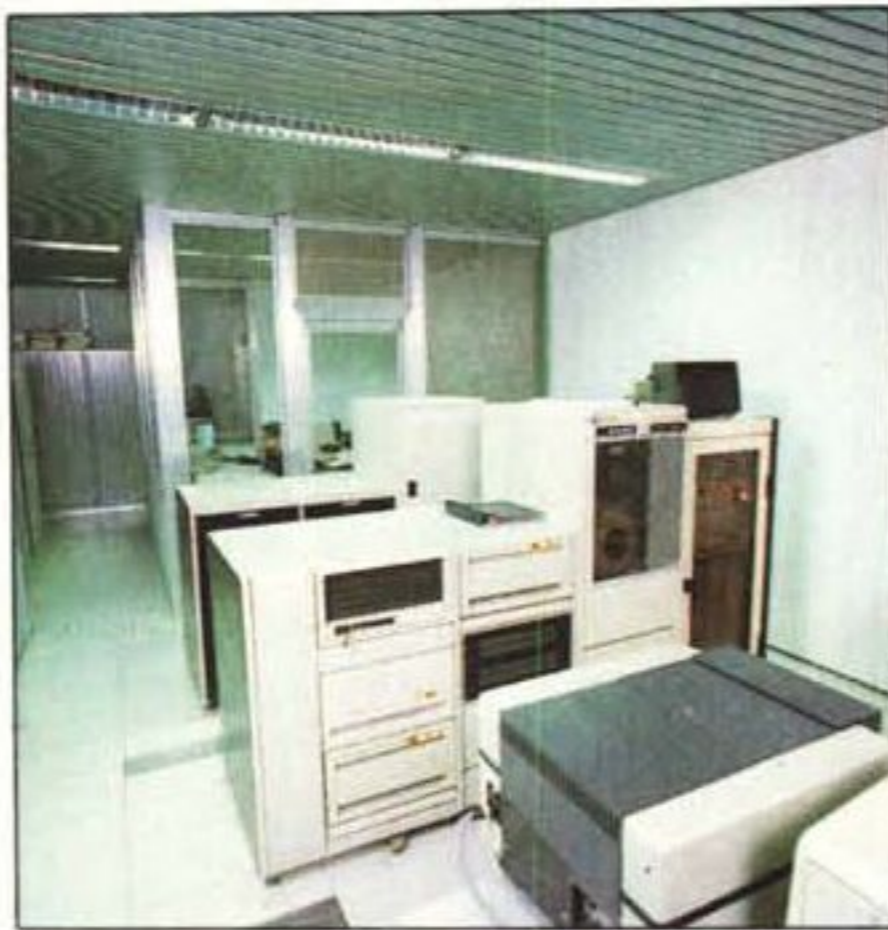
Al C.N.M.C.A. è operante anche una stazione computerizzata per la ricezione e l'elaborazione digitali di immagini Meteosat. Lavorando in modo svincolato da Afrodite, questa sezione raccoglie ed interpreta le immagini che il satellite invia ogni mezz'ora. Dispone di due PDP-11 con hardware addizionale per l'immagine processing di qualità.
