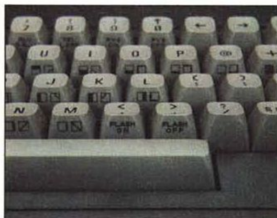
I tasti FLASH permettono di programmare delle scritte lampeggianti.
