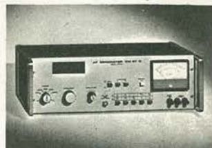
Generatore AM-FM stereo "TES" Mod. AF 1077 Frequenza: AM 140 kHz - 50 MHz FM: 9,5-12 MHz e 85-110 MHz Tensione d'uscita: 0,1 µV - 0,1 V Impedenza: 75 Ω Modulazione: interna-esterna Sottoportante: 19 kHz e 38 kHz
