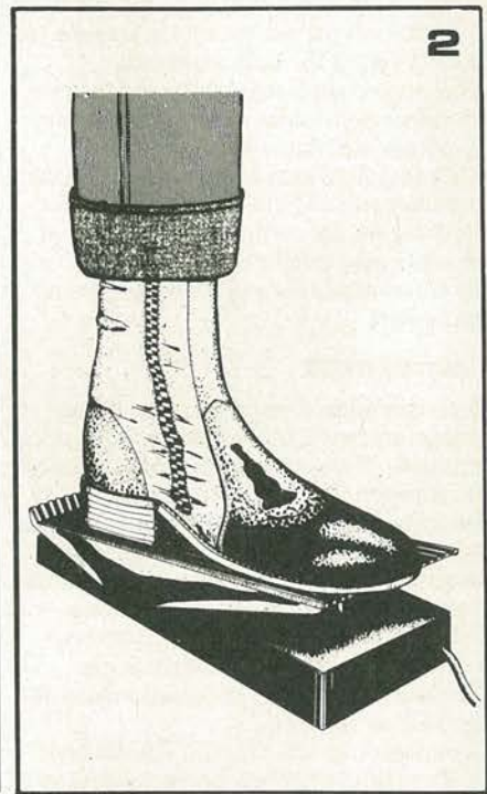
Figura 1. Schema elettrico del mini-phasing Figura 2. Pedale che aziona P2
