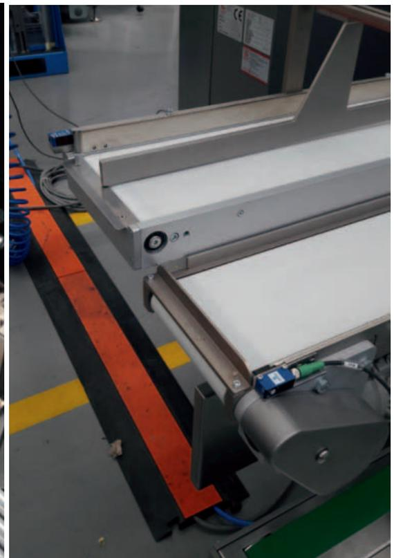
*I sensori optoelettronici Wenglor sono stati utilizzati su macchine e linee di confezionamento per rilevare e contare gli oggetti in modalità contactless*
