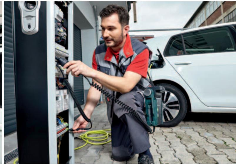
Test di sicurezza elettrica con ProfiTest MXtra (fonte: Gossen Metrawatt)
