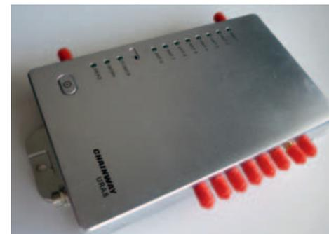
*URA8 di Chainway è il reader RFID in banda UHF dotato di sistema operativo Android 9.0 e 8 canali d'antenna (multiplexer interno)*
