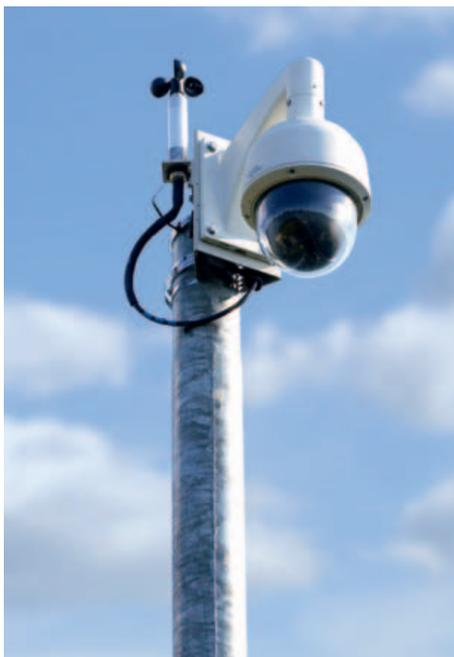
Figura 5 - La velocità corrente del vento viene registrata tramite un anemometro
