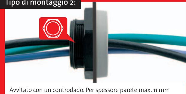
Avvitato con un controdado. Per spessore parete max. 11 mm
