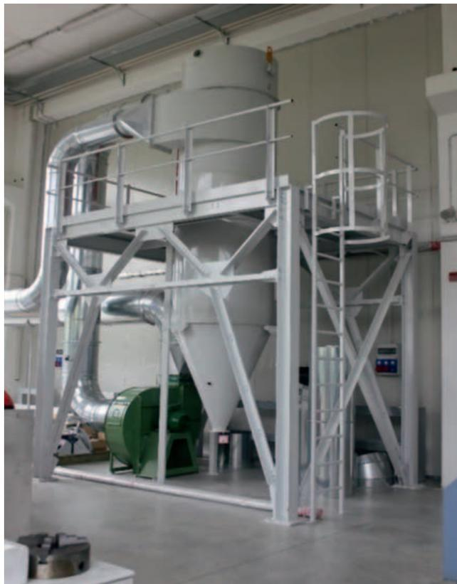
Figura 2 - Impianto di aspirazione dell'aria con separatore ciclonico per l'abbattimento delle polveri
