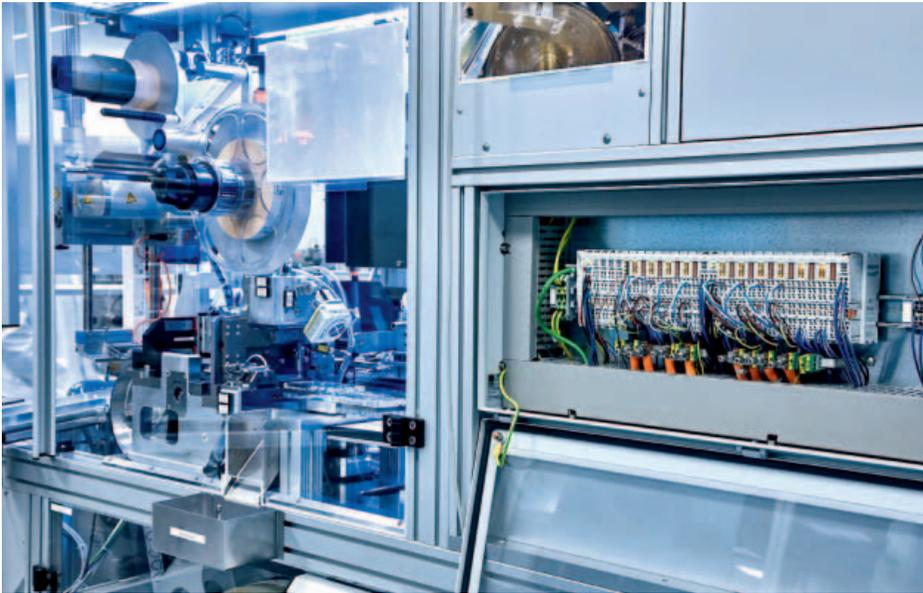
*I terminali per servomotori EL7211 (a destra) assicurano sequenze di movimento precise che coinvolgono più assi in modo particolarmente compatto*
