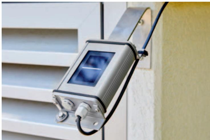
*Figura 8 - Il sensore di irraggiamento consente di calcolare le massime rese possibili del parco di tracciamento e di trarre conclusioni sulle prestazioni del parco*
