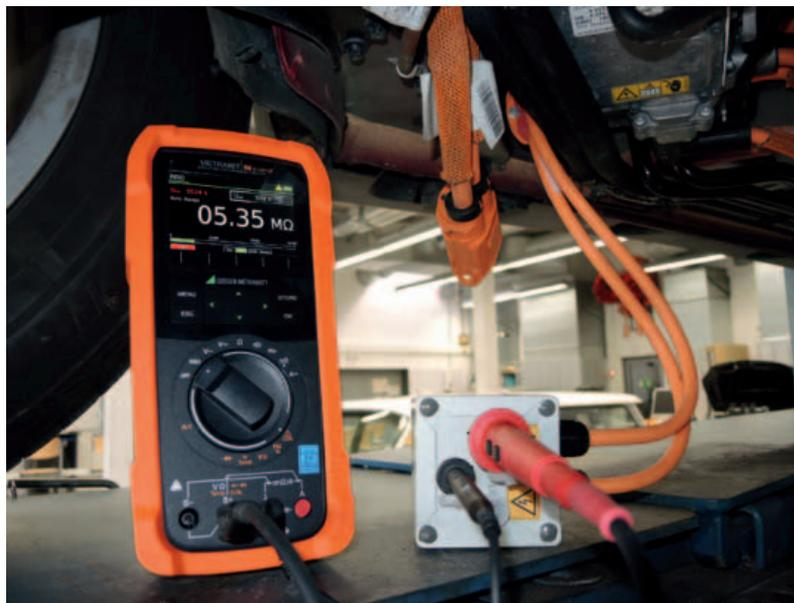
*Test di isolamento con MetraHit IM E-Drive nella gamma di veicoli ad alta tensione (fonte: Gossen Metrawatt)*
