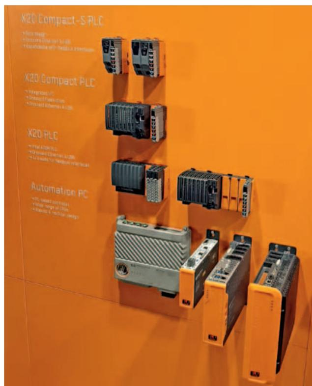
*Il sistema di controllo programmabile compatto X 20 di B&R è basato su un'architettura di tipo PC ed è adatto ad applicazioni mobili, grazie alle sue caratteristiche di robustezza, alte prestazioni e resistenza a condizioni estreme*
