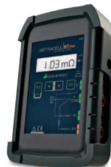
*Metracell BTpro è uno strumento che consente la valutazione, l'analisi, l'ispezione e la manutenzione di gruppi di batterie*
