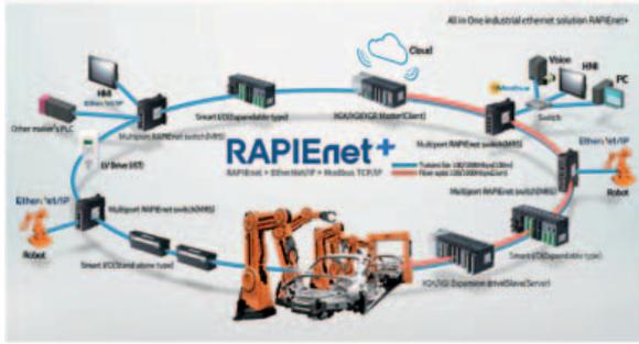
*Rapinet+ collega PLC, Drive, Hmi e molti altri dispositivi di terze parti convogliando nel Ring anche i protocolli Ethernet/IP e Modbus TCP/IP*
