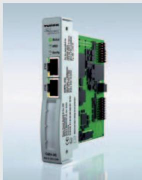
*Il gateway excom GEN-3G di Turck Banner porta segnali dalla Zona 0 al sistema di controllo, con elevate velocità di trasferimento dati*
