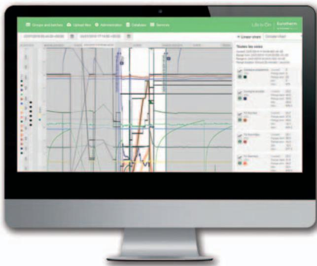
*L'architettura di sistema realizzata da Eurotherm consente una tracciabilità completa del flusso di dati e un accesso sicuro alle variabili di processo, nel pieno rispetto delle linee guida Alcoa(+)*
