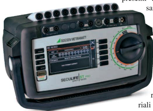
*Il nuovo Seculife ST Pro di GMC Instruments è particolarmente adatto per effettuare in completa sicurezza il test e la verifica elettrica della strumentazione medicale*
