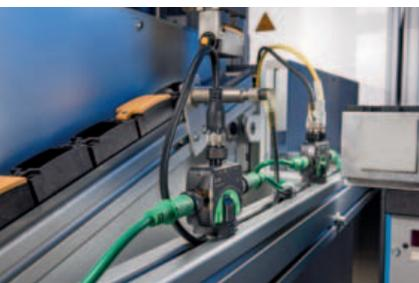
Il sistema di cablaggio intelligente SmartWire-DT di Eaton collega i componenti della macchina con connettori abilitando lo scambio di dati
