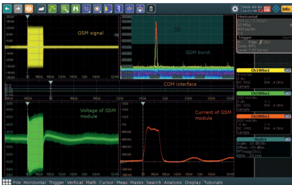
Figura 4 - Caratterizzazione di tensione e corrente durante un impulso di trasmissione GSM (fonte: Rohde & Schwarz)
