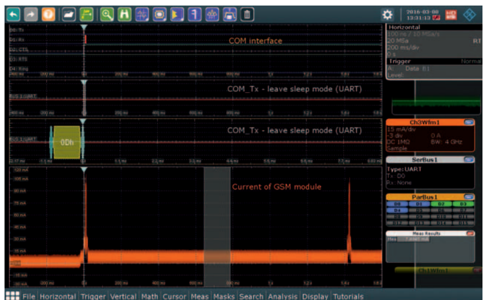
Figura 3 - Assorbimento minimo di corrente quando non è in modalità sleep (fonte: Rohde & Schwarz)
