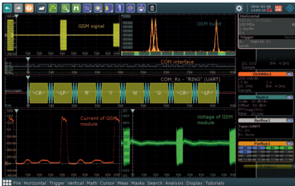
Figura 5 - Test funzionale dell'intero sistema durante una chiamata (fonte: Rohde & Schwarz)
