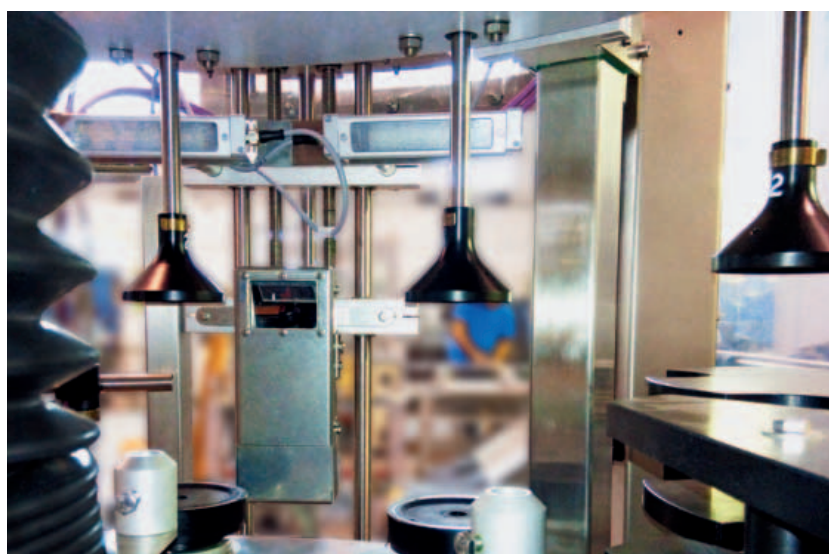
La macchina orienta i contenitori in modo che siano messi esattamente al punto giusto
