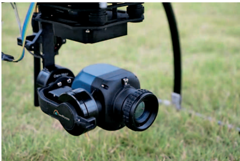
Particolare del sistema di ripresa termico
