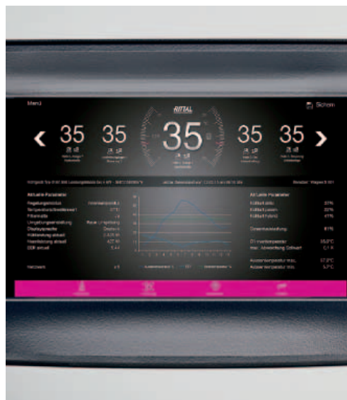
Con una soglia a +35 °C, Blue e+ utilizza la modalità heat pipe, che permette lunghi periodi di funzionamento in modalità passiva
