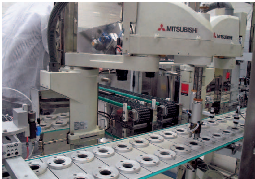
La linea produttiva di Omnicos utilizza sei robot Scara di Mitsubishi Electric
