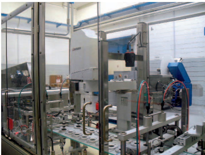
Una parte della linea di assemblaggio, lunga 18 m, dove sono lavorati i contenitori per prodotti di cosmetica
