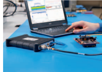
L'analizzatore di spettro portatile USB Tektronix RSA306B monitora lo spettro in frequenza e cattura segnali impulsivi
