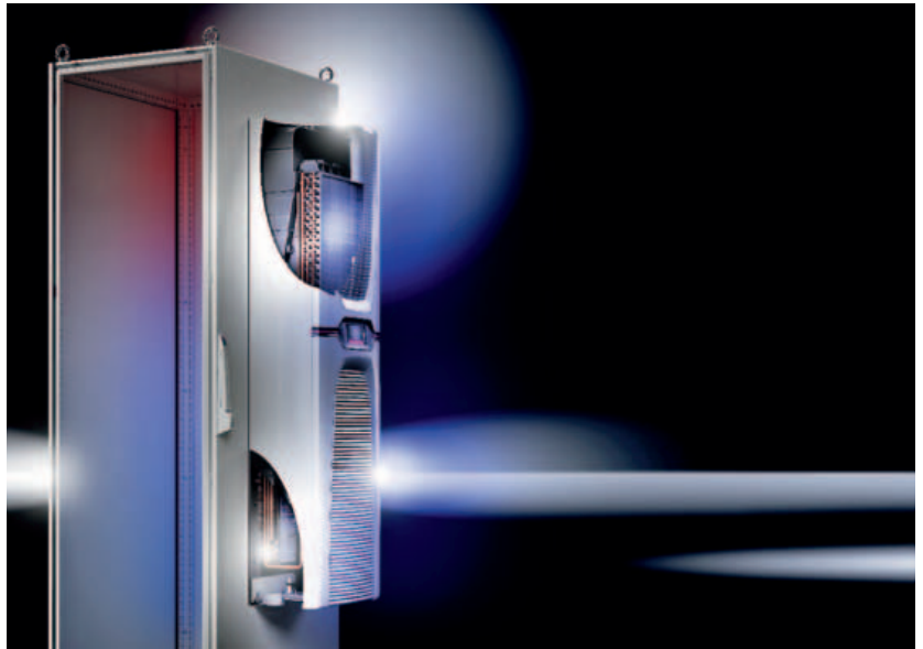
Rittal ha realizzato un sistema di raffreddamento ibrido che utilizza un sistema heat pipe, nella modalità passiva, e un compressore con ventilatori a velocità variabile, in modalità attiva
