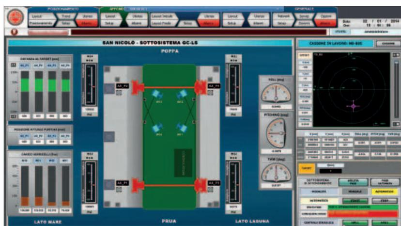
Con il software Movicon è stato sviluppato il sistema di controllo per l'automazione della posa dei cassoni del Progetto Mose per le bocche di Lido San Nicolò e Malamocco
