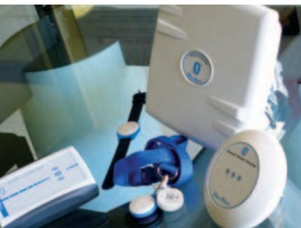
*Il dispositivo BlueWave, posizionato nella zona da controllare, riceve i dati trasmessi dai tag beacon fino ad una distanza di 100 m*
