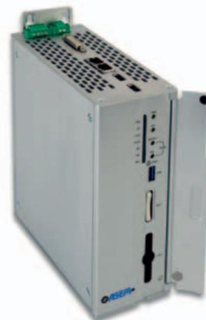
I nuovi LB 2200 di Asem sono dei PAC fanless con elevate capacità di calcolo
