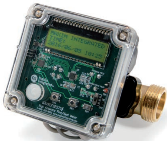
Il sistema di misura di flusso realizzato da Maxim Integrated, completo e facile da usare, può funzionare fino a vent'anni con una sola batteria
