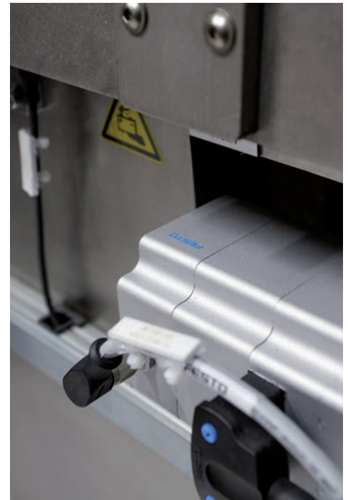
Il motore passo-passo EMMS-ST di Festo aziona l'apertura e la chiusura degli alloggiamenti delle batterie sottoposte ai test di fatica nel laboratorio ZSW
