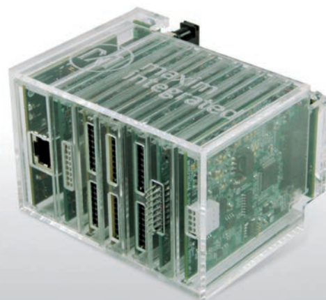
I moduli di riferimento della piattaforma Micro PLC di Maxim sono grandi quanto una carta di credito
