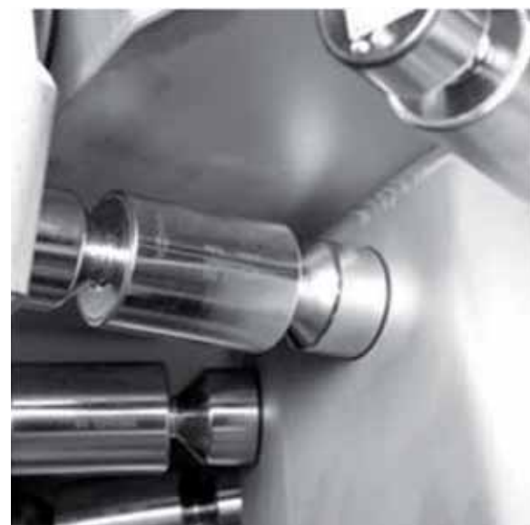
Cella di carico PW27 installata in una pesatrice multitestata
