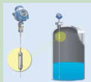
Verification Reflector permette la verifica di funzionamento senza dover aumentare il livello del prodotto
