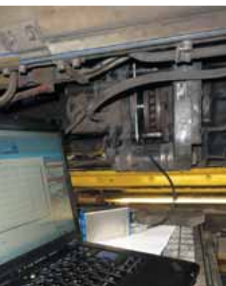
Un intervento di manutenzione, per il controllo delle pinze di un tram, effettuato con EspressoDaq
