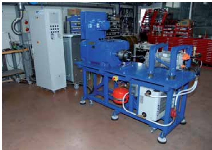
Il banco prova di Dynosens per il test dei motori elettrici
