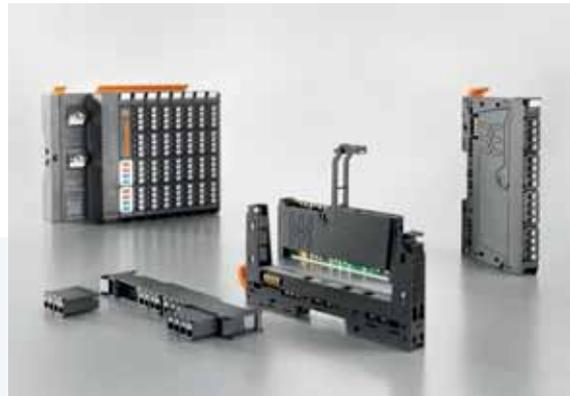
*I moduli del sistema di I/O u-remote sono composti da uno zoccolo di collegamento alla barra DIN, la scheda elettronica e un porta connettori con slot estraibili*
