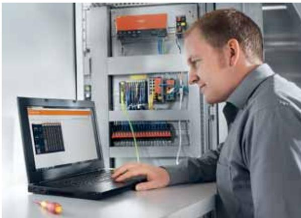
*Un web server integrato nell'accoppiatore equipaggiato con la sua interfaccia permette di eseguire dei test sul posto o in remoto*
